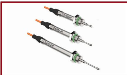
Applicabili sul fondello del cilindro idraulico od in applicazioni in pressione, il cursore a molla rileva la posizione dello stelo che non deve essere forato, ideale per retrofitting di cilindri che non devono essere forati e smontati.
