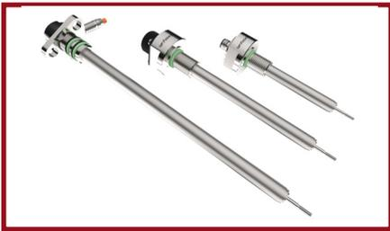
Installabili su cilindri idraulici inserendo la sonda nello stelo forato per misurarne la posizione e con la testa del sensore avvitata sul retro del fondello del cilindro.
